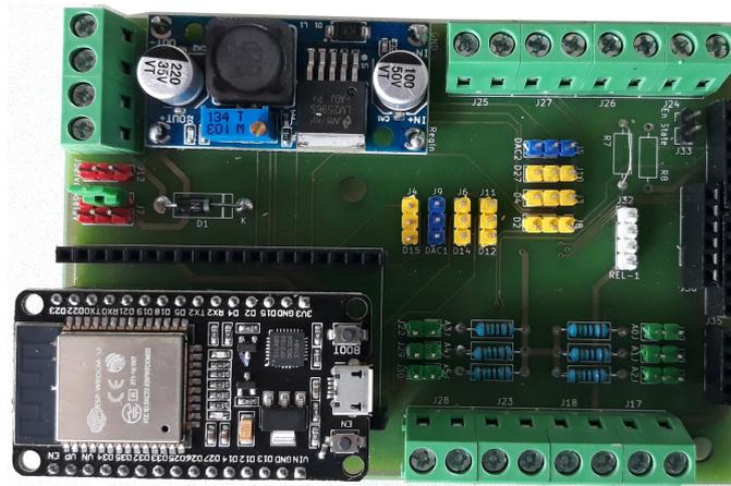
Esta placa visa facilitar o uso do módulo processador Esp32 em aplicações Industriais ou Maker.
